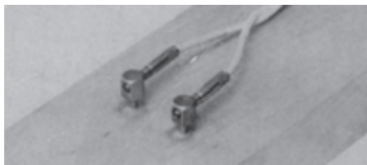
شکل ۱۴-۳- نحوه قرار گرفتن الکتروود رطوبت‌سنج در چوب
