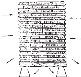
شکل ۹-۲- جریان افقی و عمودی به‌طرف پایین در یک دسته چوب
