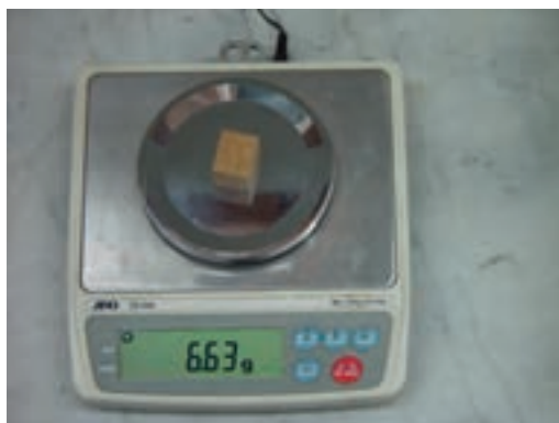
شکل ۱-۵- ترازوی دقیق و نحوه توزین نمونه چوب
