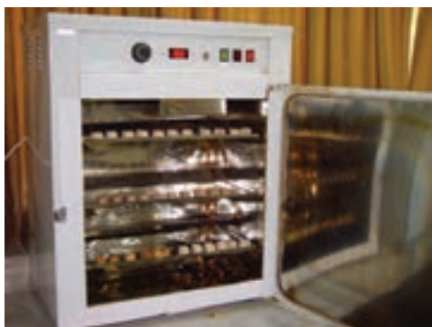
شکل ۱-۶- اتوو و نحوه قرار دادن نمونه‌های تعیین رطوبت در آن
