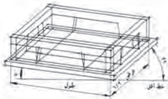
شکل ۱-۵۰- روش ترسیم طرح اولیه تصویر مجسم دیمتریکی از یک جعبه و صفحه زیر آن
