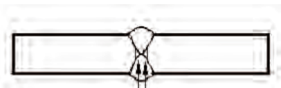
نفوذ ناقص در اتصالات شیاری دو طرفه
