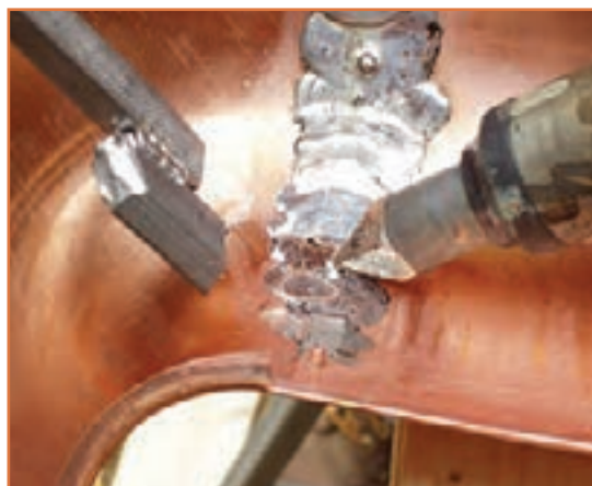
ب - لحیم کاری دو قطعه مسی
