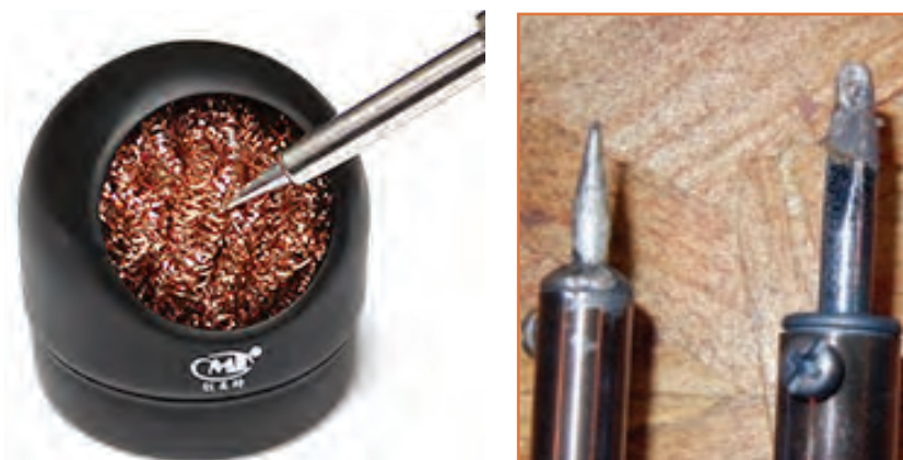
الف - تمیزکاری هویه
