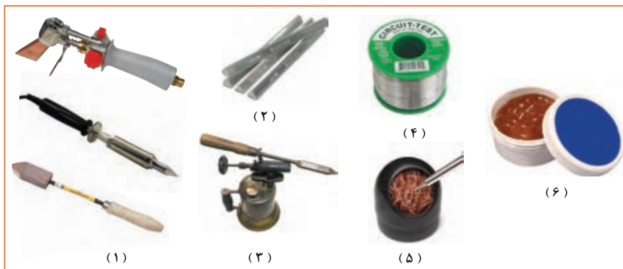
شکل ۴- تجهیزات و مواد مصرفی لحیم کاری نرم
