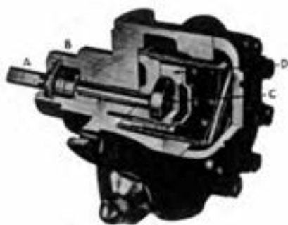
پمپ دوار یک طبقه برای مشعل های گازوئیلی فشار قوی A- محور B- کاسه نمد محور C- روتور پمپ D- بدنه پمپ
