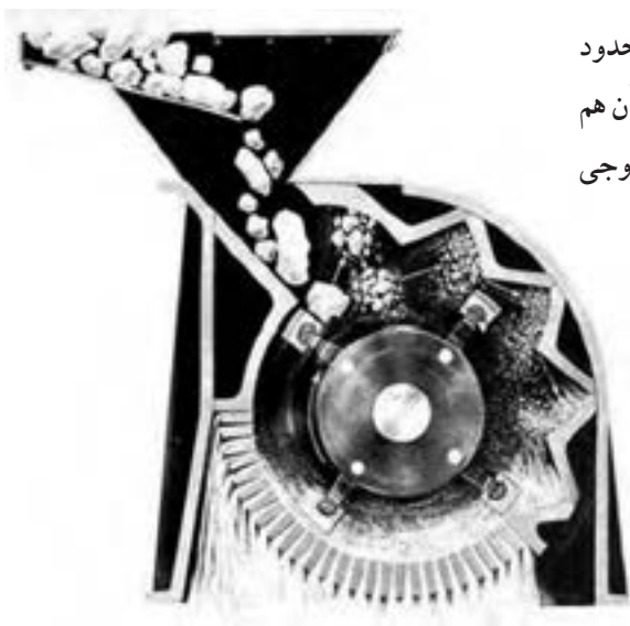
طرز کار سنگ شکن چکشی
