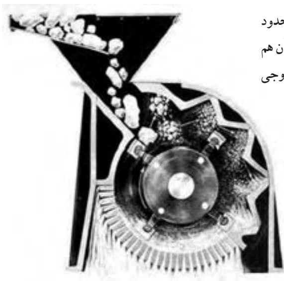
طرز کار سنگ‌شکن چکشی
