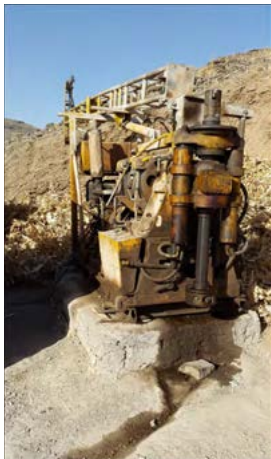
دستگاه حفاری قرار گرفته بر روی فونداسیون
