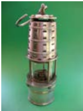
چراغ سنجنده مقدار اکسیژن در معدن
