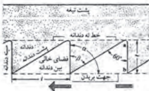
شکل ۲-۶- مشخصات دندان ارّه
