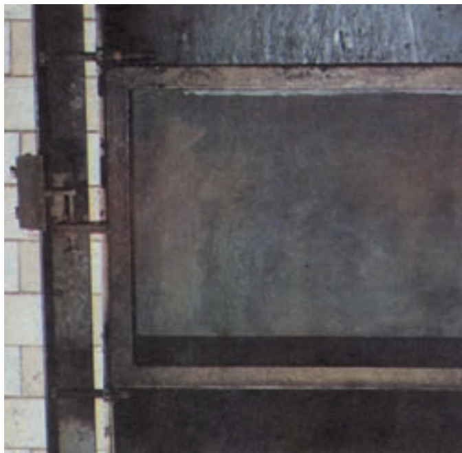
شکل ۶-۲- نحوه‌ی قرار گرفتن ریپیت‌ها روی میز چاپ
