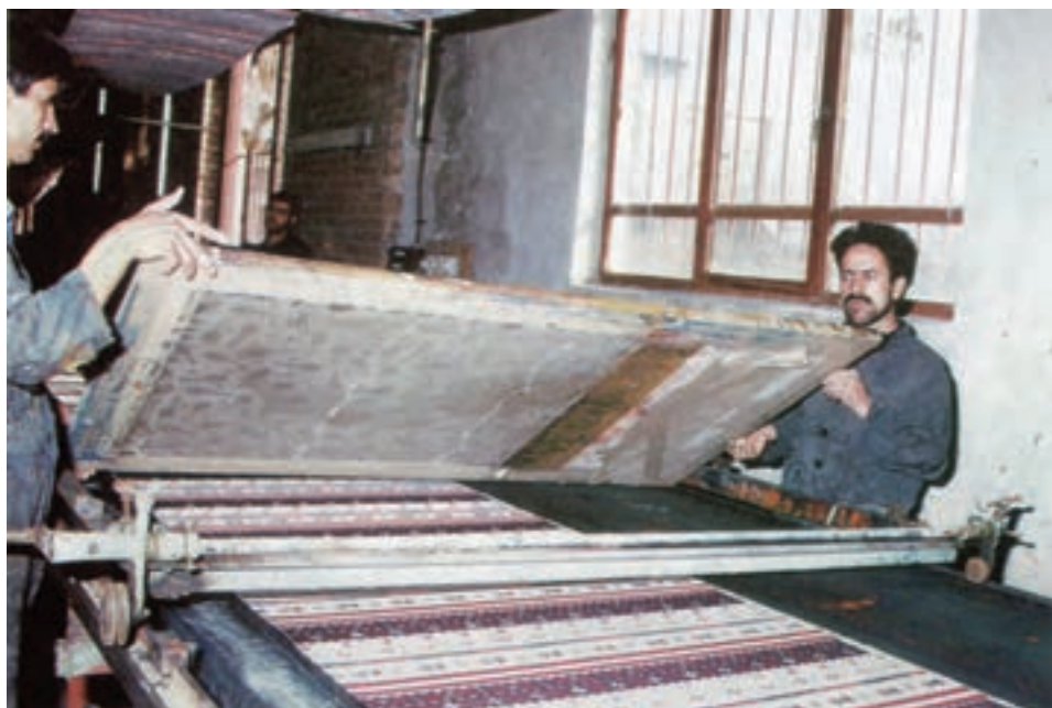
شکل ۱۳-۲ نحوه‌ی قرار دادن شابلون در دستگاه حامل
