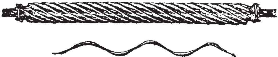
شکل ۲-۱۳- سیلندر تراش و تیغه‌ی زیرین آن
