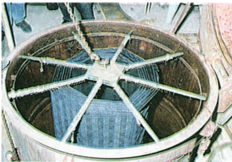
شکل ۴-۱۰- پارچه‌ی قرار گرفته در دستگاه بخار ستاره‌ای
