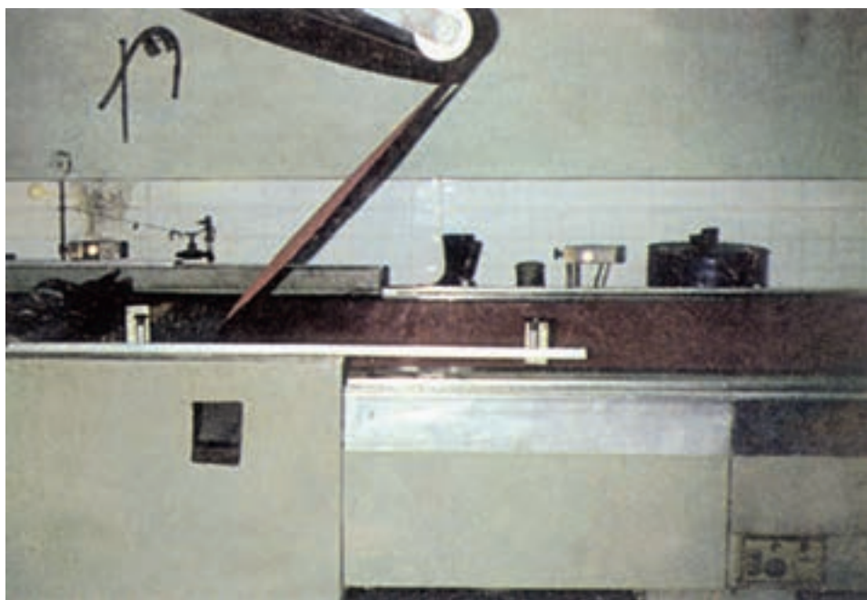
شکل ۱۷-۲- چشم‌های الکترونیکی دستگاه چاپ اتوماتیک
