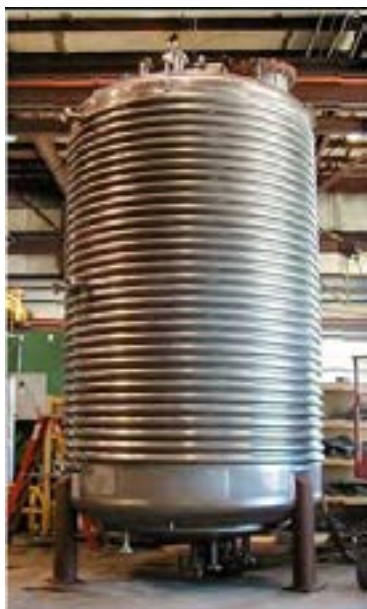
شکل ۴-۵ رآکتور ناپیوسته با سیستم حرارتی کویل
