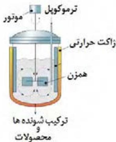
شکل ۴-۴ رآکتور ناپیوسته
