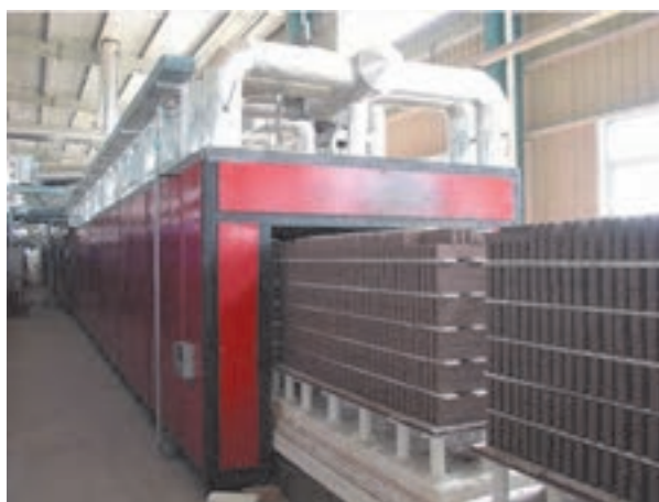
شکل ۱۹-۲ دستگاه خشک‌کن تونلی واگن‌دار
