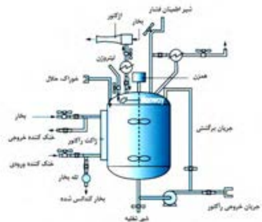
شکل ۴-۱۲ رآکتور مخزنی همزن دار مداوم
