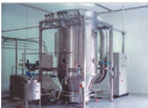
شکل ۲۴-۳-مخلوط‌کن بستر سیال
