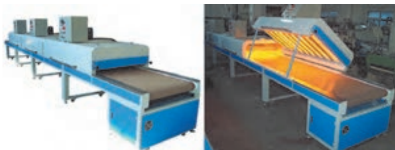
شکل ۲۰-۲ دستگاه خشک‌کن تونلی دارای نوار نقاله
