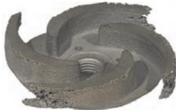
شکل ۱۸-۳ آسیب دیدگی پروانه پمپ در اثر پدیده کاویتاسیون
