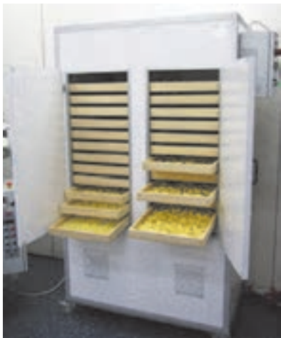
شکل ۱۸-۲ دستگاه خشک‌کن کابینتی
