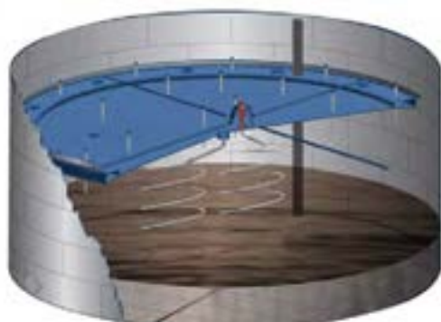
۴-۱۶ مخازن سقف شناور درونی
