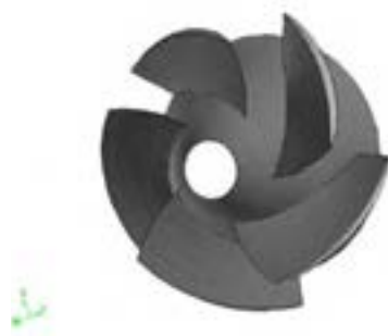
شکل ۹-۳ پروانه با جریان مختلط
