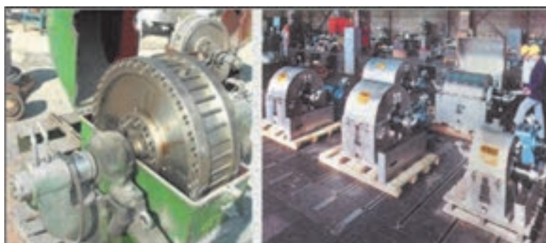
شکل ۱۷-۵ دستگاه‌های استخراج مایع - مایع گریز از مرکز
