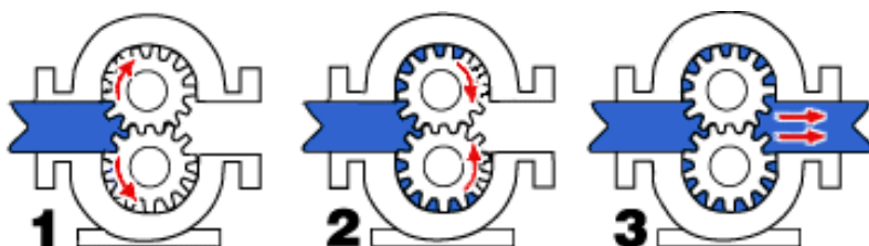
شکل ۱۵-۳ نحوه عملکرد پمپ‌های دنده‌ای
