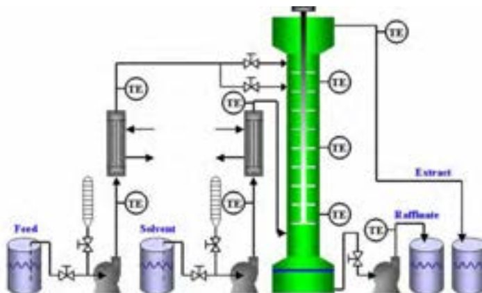
شکل ۱۶-۵ فرایند استخراج مایع - مایع با تماس دهنده‌های ستونی
