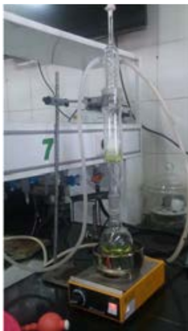
شکل ۱۸-۵ شمای ساده‌ای از سوکسوله
