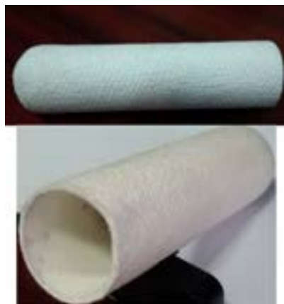
شکل ۱۹-۵ مخزن سوکسوله
