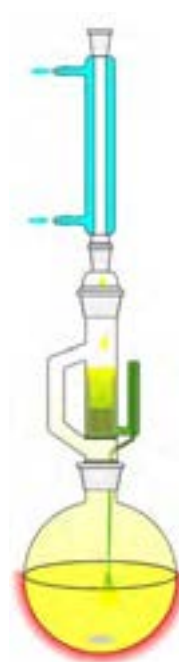
شکل ۱۸-۵ شمای ساده‌ای از سوکسوله
