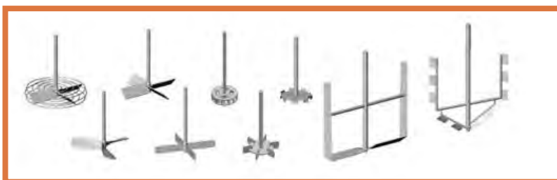
شکل ۴-۶ انواع هم‌زن‌های مورد استفاده در رآکتور
