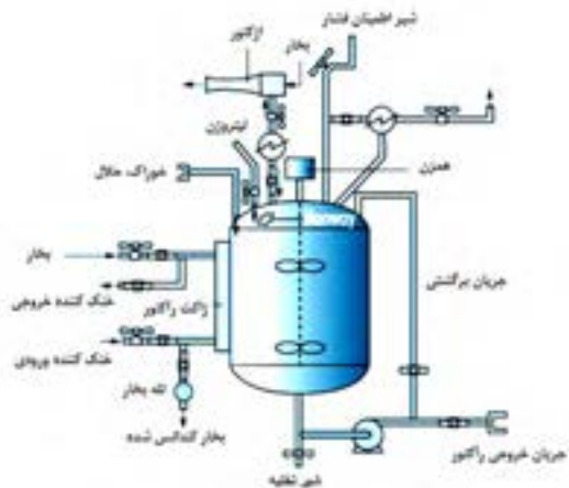
شکل ۱۲-۴ رآکتور مخزنی همزن دار مداوم
