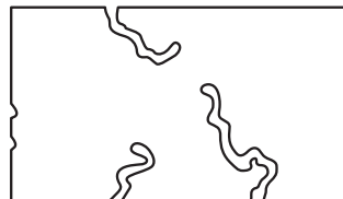
شکل ۱-۴ - تخلخل‌های باز در قطعه
