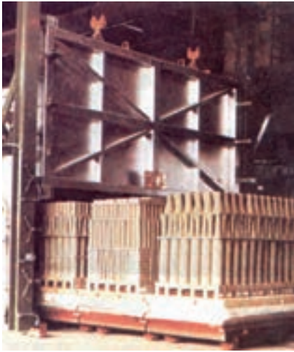
شکل ۳-۶- کوره‌ی پخت دیرگدازهای سرامیکی (واگنی) درب ورودی به وسیله‌ی دو عدد سیم بکسل بالا و پایین می‌شود.
