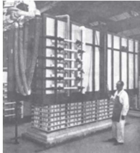
شکل ۲-۶- کوره‌های جعبه‌ای، در این کوره دیواره‌ها جابه‌جا شده بالا و پایین می‌رود.
