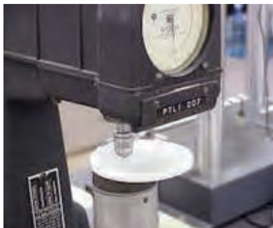
شکل ۲۲- روش‌های دستی و دستگاهی تعیین سختی
