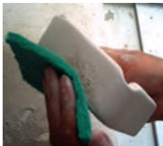
شکل ۷- پرداخت محصولات سرامیکی با ابزارهای مختلف
