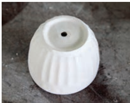
ب) اجرای پرداخت قطعات شکل‌دهی دستی با چاقوی پرداخت
