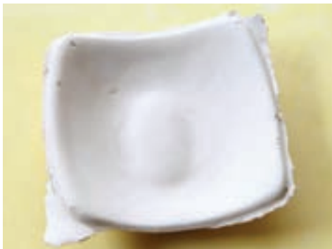
شکل ۱۰- قطعه سرامیکی دارای اضافات است
