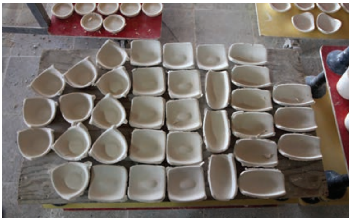
شکل ۱۲- ناهمواری و زوائد روی سطح قطعات مختلف سرامیکی
