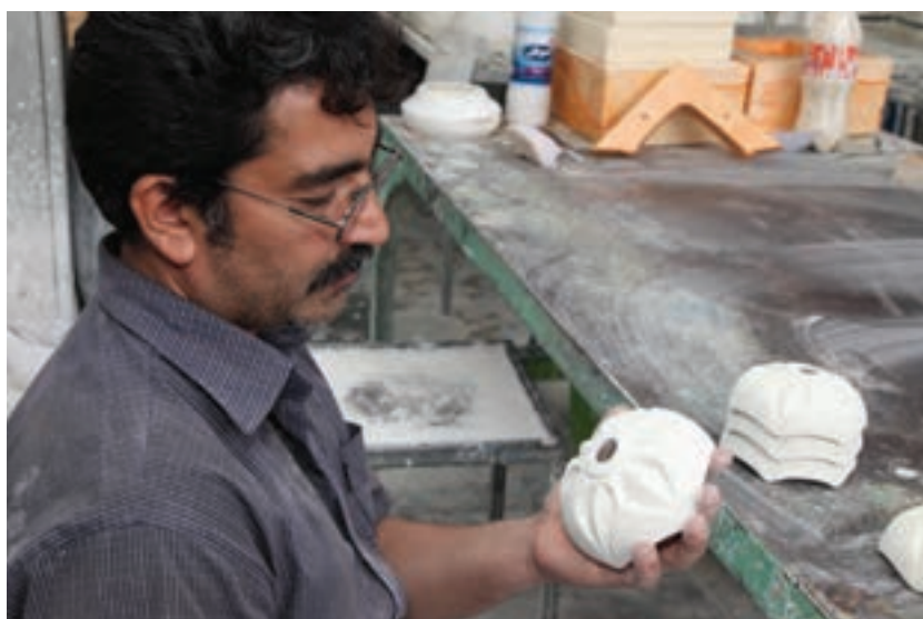
شکل ۱۵- کنترل چشمی فرآورده های سرامیکی تولید شده به روش دستی
