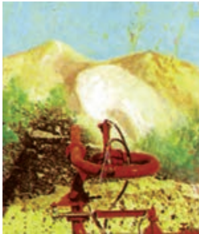
شکل ۱-۳- یک جت آب برای استخراج کائولین
