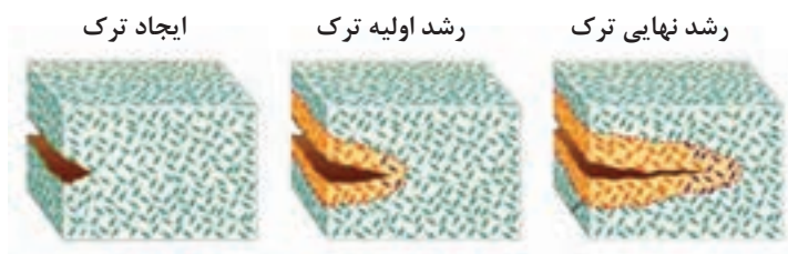
شکل ۲۶- گسترش ترک و مقاومت ماده در برابر آن (چقرمگی)
