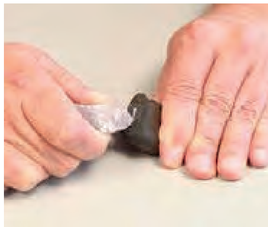
شکل ۲۲- روش‌های دستی و دستگاهی تعیین سختی
