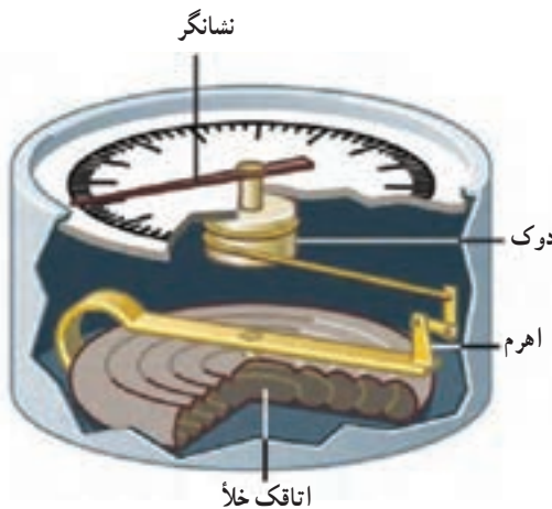
تصویر ۲-۲ — ساختمان فشارسنج فلزی ساده
