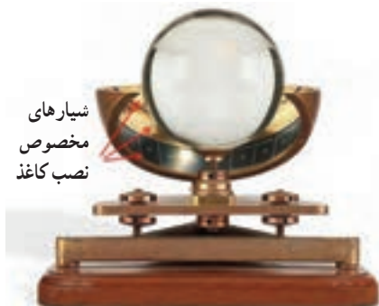
تصویر ۳-۵ آفتاب‌نگار کمپل استوکس
