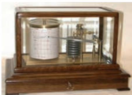
تصویر ۳-۲- دستگاه فشارنگار
