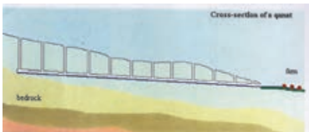
شکل (۱-۱) - سطح مقطع قنات و کانال آن
