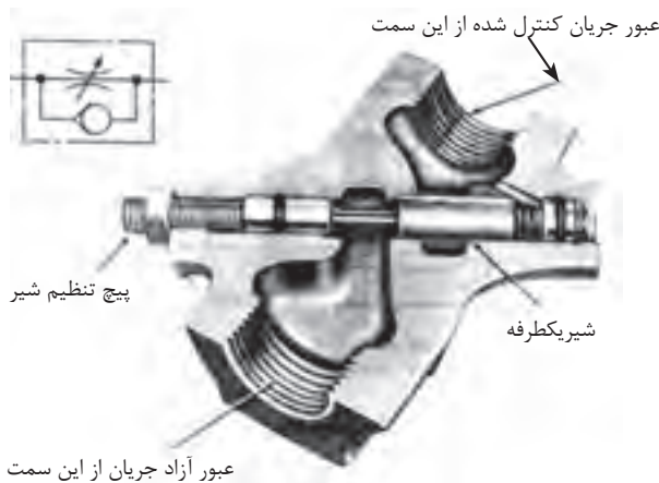
شکل ۵-۸- شیر کنترل مقدار جریان از نوع بدون تصحیح‌کننده فشار (مدل سوزنی)
