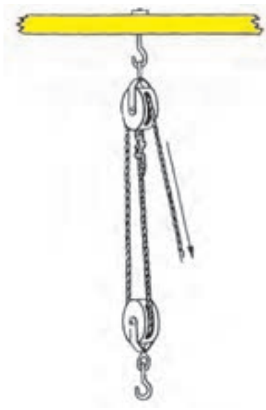
شکل ۵-۱۳- ترکیب قرقره ثابت و متحرک
