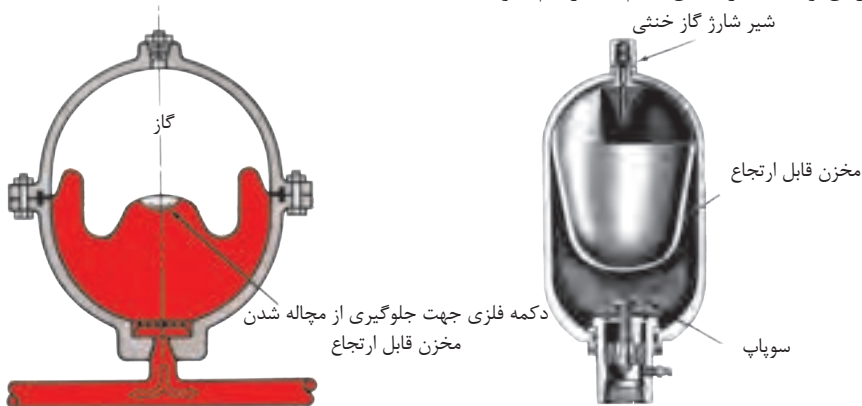
شکل ۴-۱۰-آکومولاتور گازی نوع دیافراگمی
