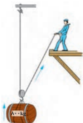
شکل ۵-۱۱- قرقره متحرک
