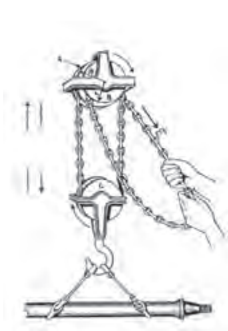
شکل ۵-۱۶- مجموعه قرقره زنجیری
