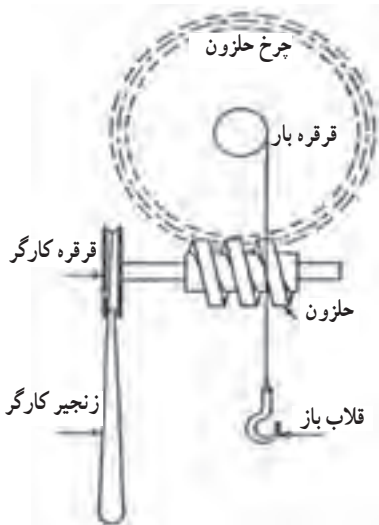
شکل ۵-۲۱- میله حلزون و چرخ حلزون بالابر
