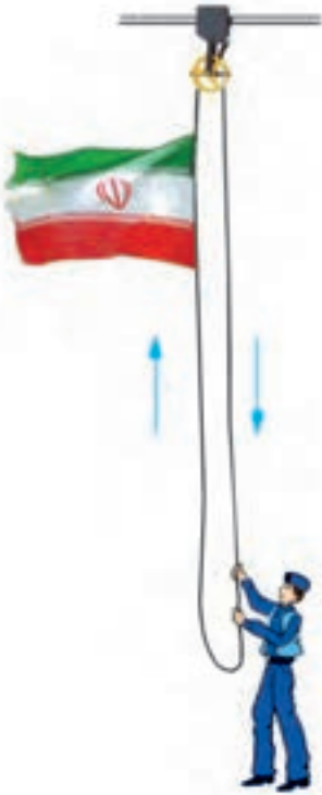
شکل ۵-۹- قرقره و طناب در قرقره ثابت تک‌شیاره
