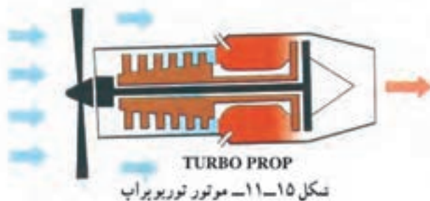
Annular combustion chamber. شکل ۱۲-۱۱ - محفظه احتراق حلقوی
