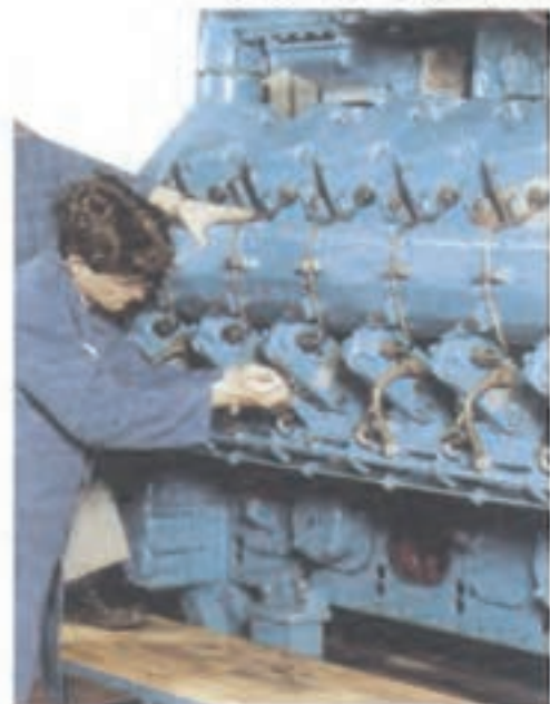
شکل ۱-۱۶- آماده کردن پمپ نفت افشان
