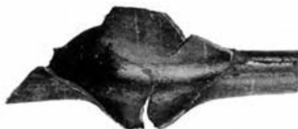
شکل ۴-۱۴- پارگی شدید تیوب سوپر هیترو
