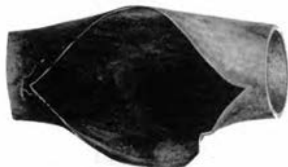
شکل ۵-۱۴- پارگی تیوب تولید
