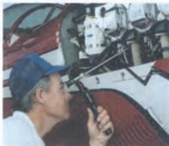
شکل ۱-۱۷- استفاده از بوریسکوپ در بازدیدهای داخلی
