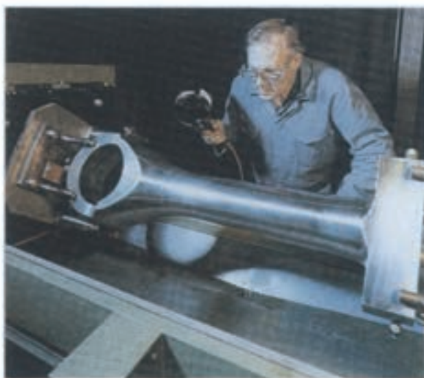
شكل ۳-۱۶- بازديد به روش ذرات مغناطیسی از هرگونه ترك در شاتون
