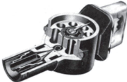
شکل ۳-۴- نمایی از یک مگنترون نوع حفره‌ای
