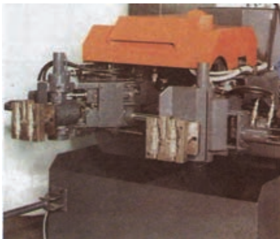
شکل ۳-۲۴— ماشین ریخته‌گری ریزه تمام اتوماتیک
