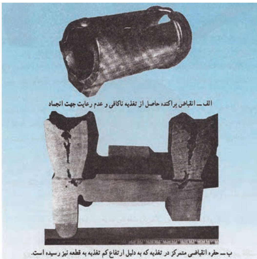
شکل ۲-۱۸- کشیدگی و حفره های انقباضی
