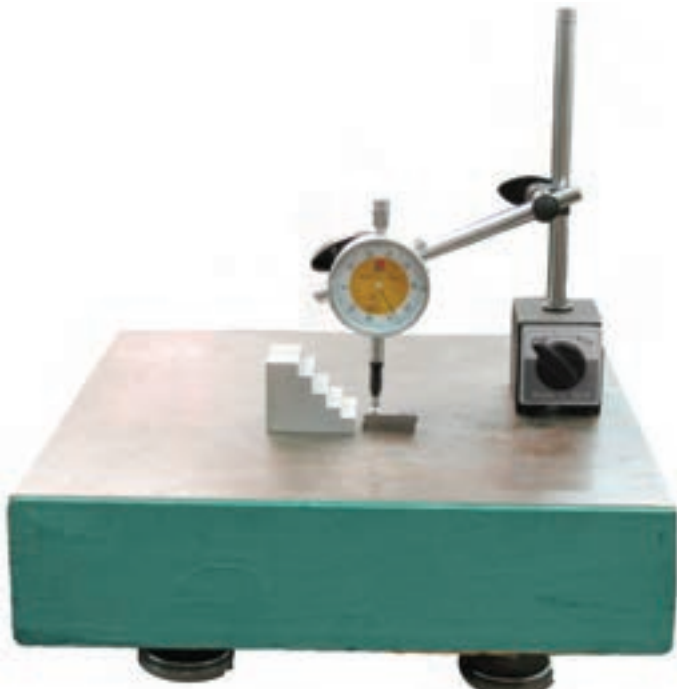
شکل ۸-۱۷- اندازه‌گیری ارتفاع پله‌ها
