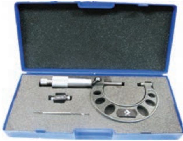
شکل ۱۵-۱ میکرومتر با گستره اندازه‌گیری (۰.۰۵-۲۵) میلی‌متر
