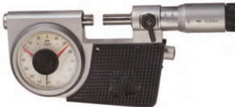
شکل ۲۹-۵- میکرومتر عقربه‌دار با صفحه دایره‌ای شکل
