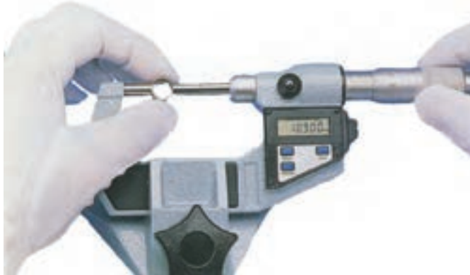
شکل ۳۱-۵ اندازه‌گیری به وسیله میکرومتر دیجیتالی
