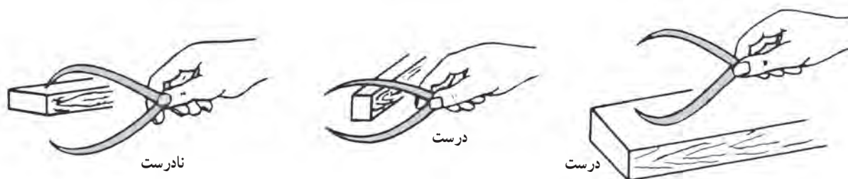
شکل ۲-۲۷- تنظیم دهانه پرگار انتقال اندازه خارج
