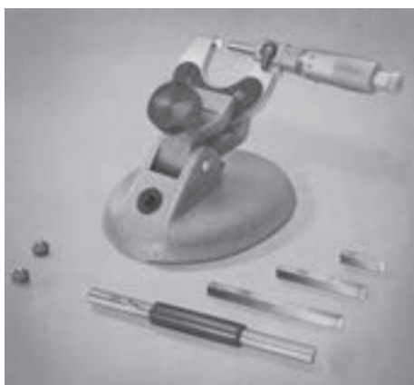
شکل ۲۳-۵- بستن میکرومتر به گیره مخصوص (پایه مخصوص)
