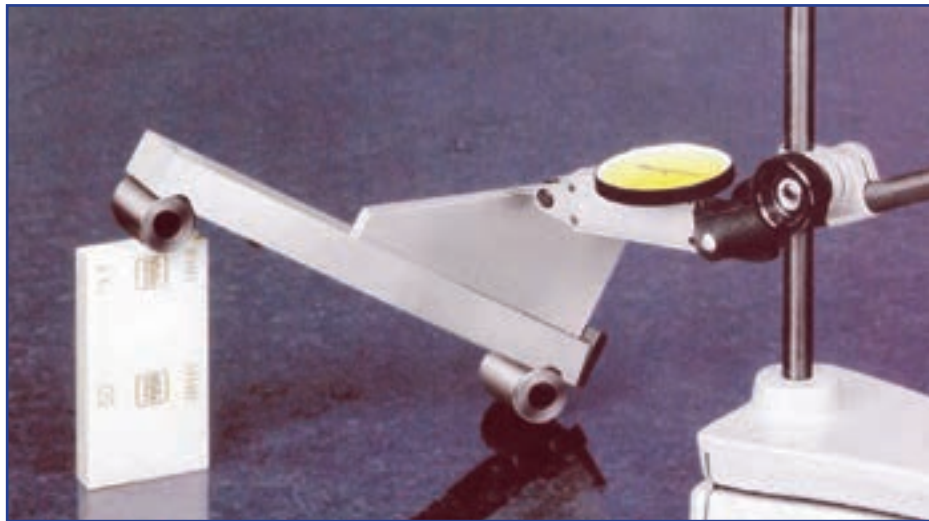
شکل ۷-۱۶- اندازه‌گیری زاویه به کمک خطکش سینوسی
