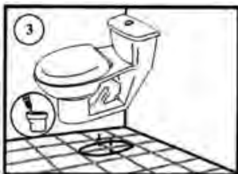
شکل ۴-۱۰-پ - آب بندی بوگیر و استقرار توالت فرنگی
