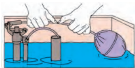
شکل ۴۲-۱۰- تنظیم نمودن یک نوع شیر شناور
