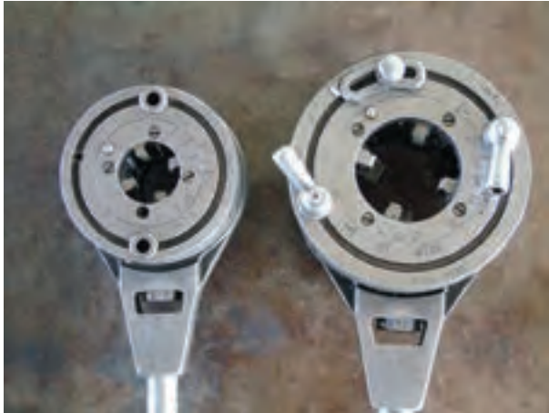
شکل ۱-۳-ب- دو نوع حدیده چهار پارچه قابل تنظیم
