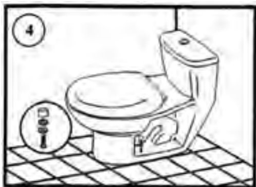
شکل ۴-۱۰-ت - محکم کردن پیچ های استقرار
