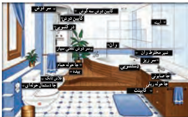
شکل ۵۲-۱ تجهیزات نصب شده در یک حمام بزرگ داخل ساختمان
