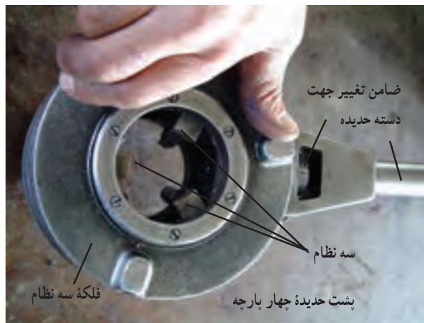
شکل ۱-۳-ب- اجزای حدیده چهار پارچه
