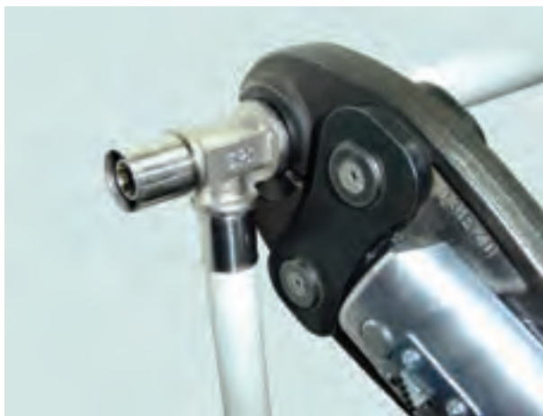
شکل ۱۱-۴- نحوه کار با دستگاه پرس
