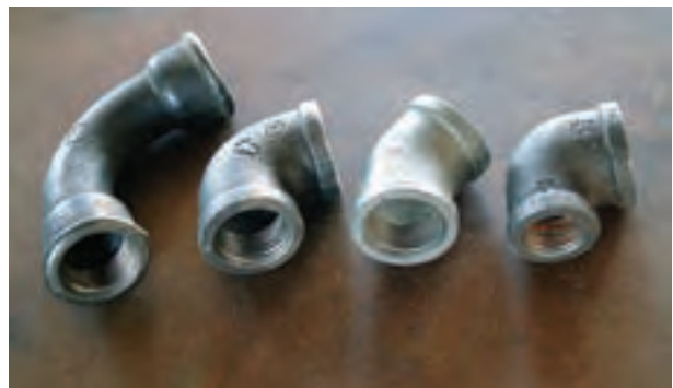
انواع زانویی (زانویی تبدیل، 45^{\circ} ، 90^{\circ} و خم بلند)
