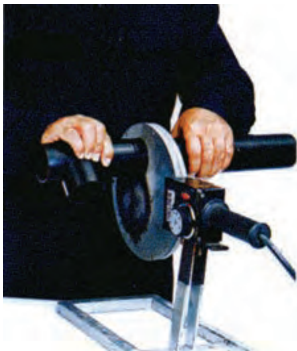
شکل ۷-۳- گرم کردن دو سر اتصال
