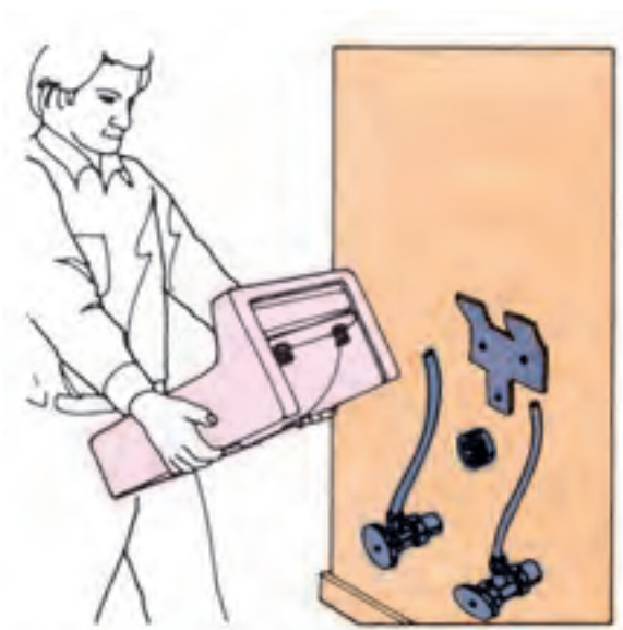
شکل ۲۰-۱۰- مراحل نصب دست شویی بدون پایه
