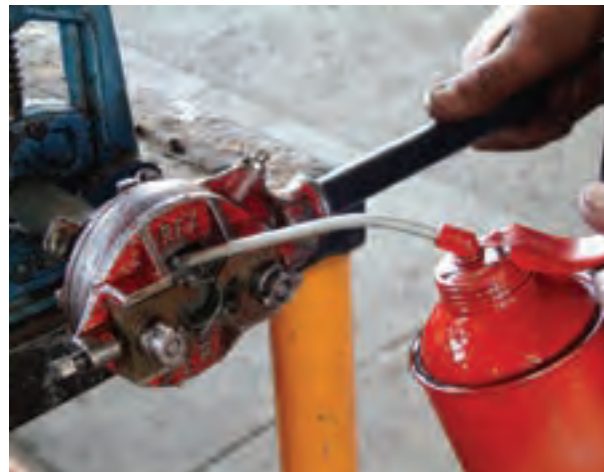
شکل ۱-۳۴ - ریختن روغن برای روانکاری و خنک‌کاری
