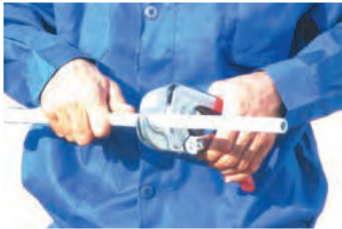
شکل ۲-۴- بریدن لوله با قیچی
