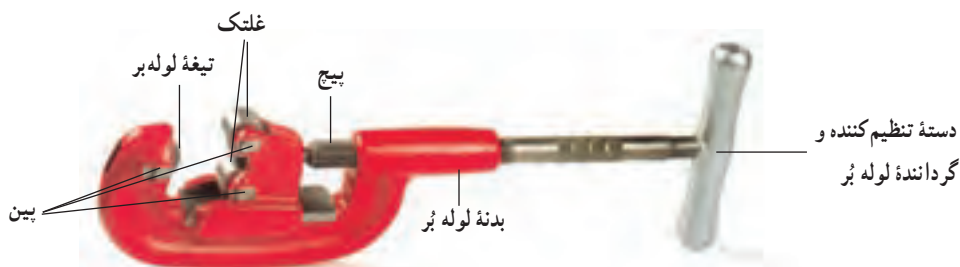
شکل ۱-۲۱- اجزای یک لوله‌بر فولادی
