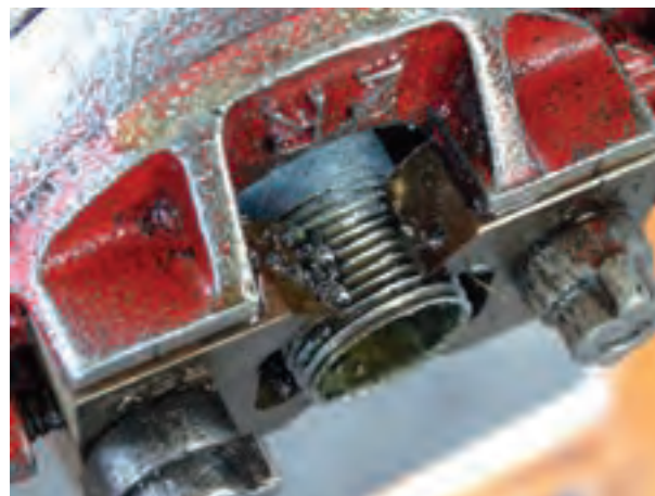
شکل ۱-۳۵ - پایان حدیده‌کاری با عبور دو دندان از سر لوله
