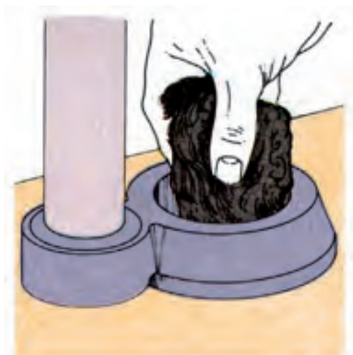
شکل ۴۴-۱۰- رسوب زدایی نشیمنگاه زیراب
