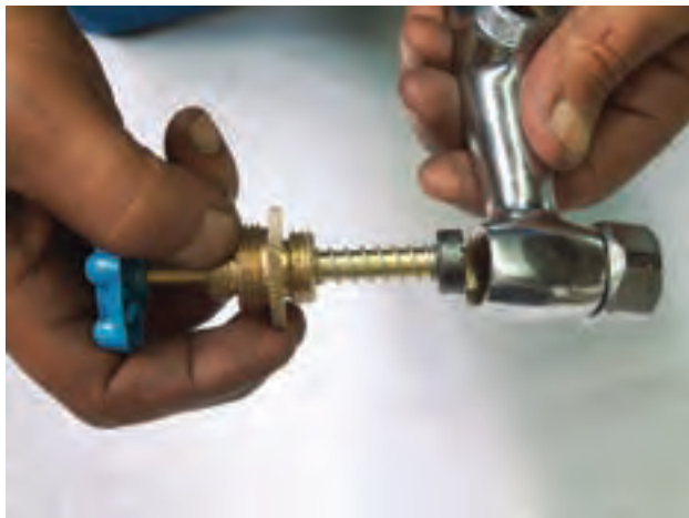
ب) قرار دادن کف تراش در شیر
