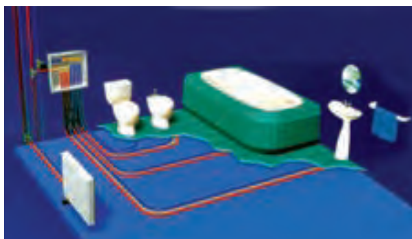
شکل ۳-۳- اجرای لوله‌کشی و ساییل بهداشتی با استفاده از لوله‌های PEX
