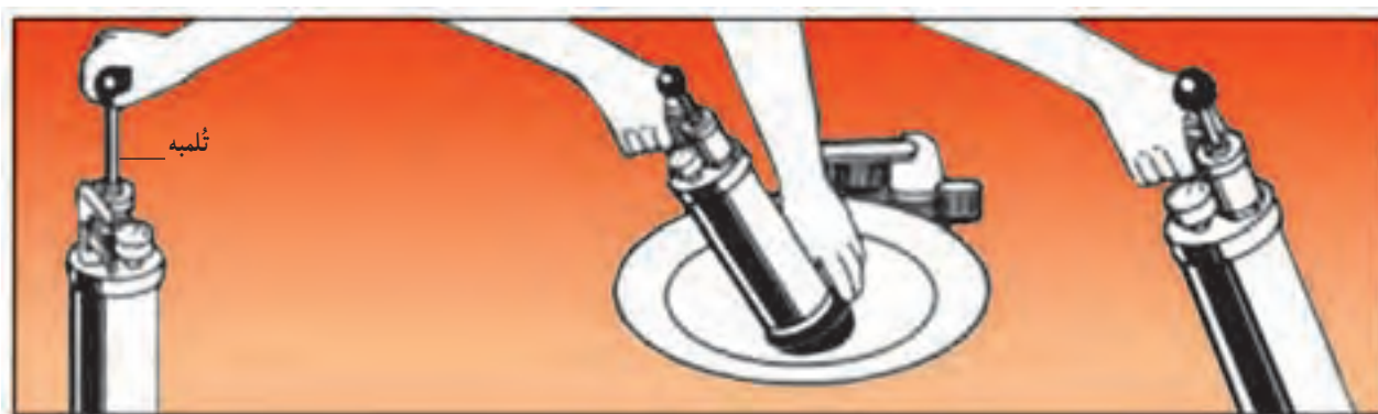
مرحله سه: کشیدن ضامن و تخلیه هوای درون مخزن مرحله دو: قرار دادن دستگاه درون مجرای مسدود شده مرحله یک: ثلمبه زدن
