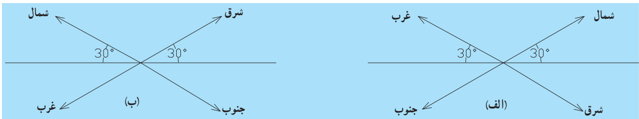
شکل ۷-۳- جهت‌های ایزومتریک در لوله‌کشی گاز
