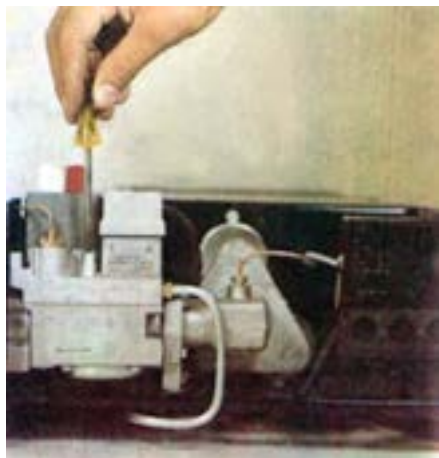
شکل ۳۲ - ۵ - تنظیم شعله پیلوت
