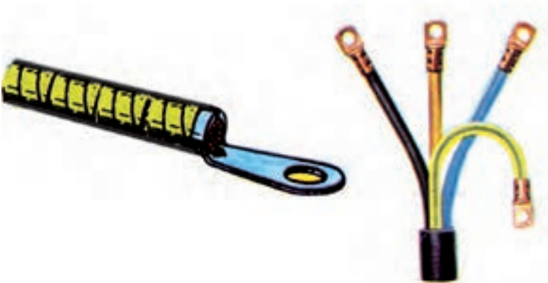
شکل ۴-۴- سه روش اتصال کابل شو به کابل
