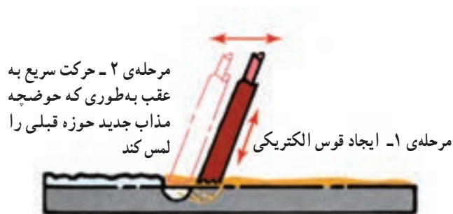
شکل ۳-۴- تشکیل مهره جوش
