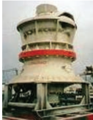
الف - نمای خارجی سنگ شکن
