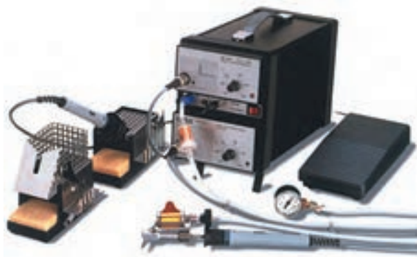
شکل ۶۷-۱- دستگاه قلع کش با کنترل حرارت الکترونیکی
