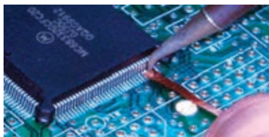
شکل ۱-۷۵- جدا کردن آی سی با فتیله لحیم
