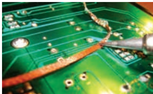
شکل ۱-۷۴- چگونگی استفاده از فتیله لحیم
