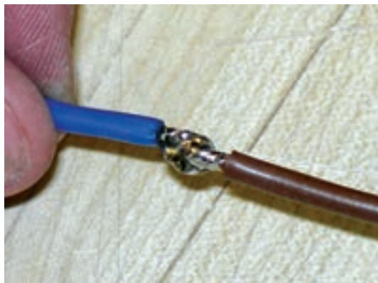
شکل ۱-۵۵- نمونه دیگری از لحیم کاری قابل قبول
