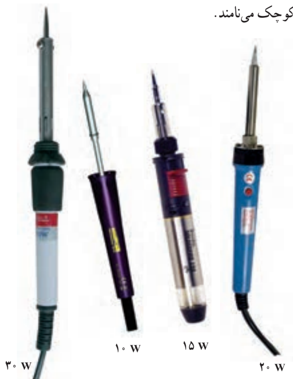
شکل ۱-۳۱- چند نمونه هویه با وات کم
