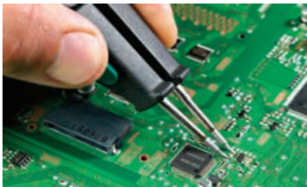
شکل ۸۸-۱- استفاده از هویه پنسی شکل
