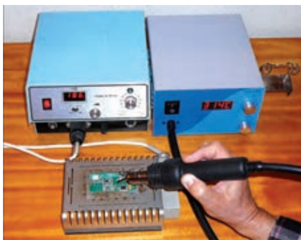
شکل ۸۶-۱- هویه با تنظیم دمای الکترونیکی
