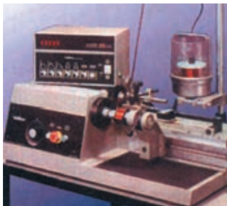
شکل ۲-۹ دستگاه بوبین پیچ
