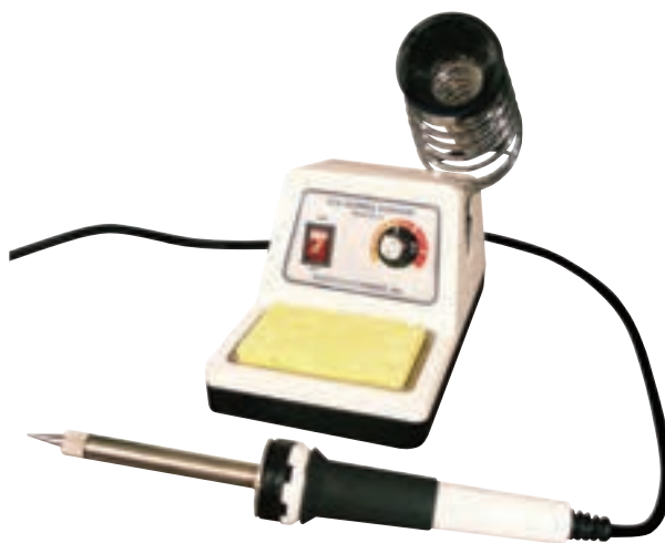
الف) تنظیم درجه حرارت با ولوم
