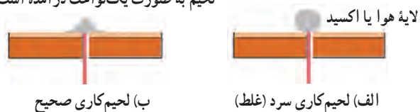
شکل ۱-۴۵ لحیم کاری صحیح و غلط
