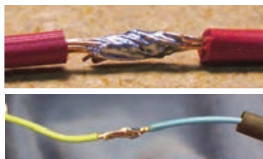
شکل ۱-۵۴- دو نمونه لحیم کاری قابل قبول
