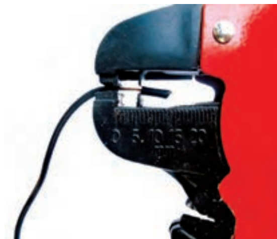
شکل ۱-۴۹- لخت کردن سیم
