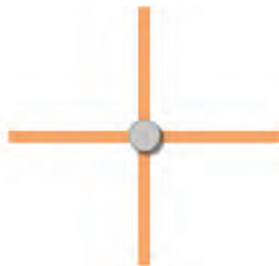
شکل ۱-۵۷- نمونه صحیح اتصال عمود برهم
