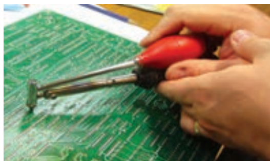
شکل ۱-۷۶- دمو نتاژ قطعات با استفاده از قلع کش حرارتی
