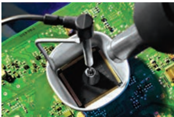
شکل ۹۰-۱- استفاده از هویه هوای گرم برای مونتاژ و دمونتاژ
