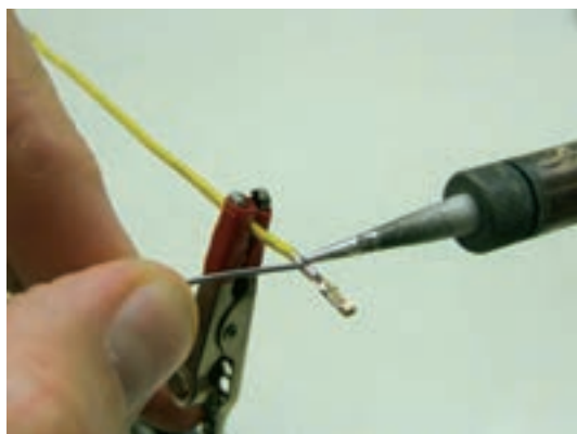
شکل ۱-۵۰- لحیم کاری به کمک گیره
