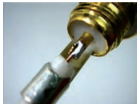
شکل ۱-۹۷- اتصال کابل کوآکسیال به BNC
