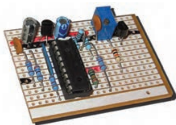
شکل ۱-۱۰۴- یک نمونه مدار کامل روی فیبر سوراخ‌دار
