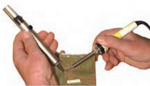
شکل ۱-۷۳- نمونه دیگری از کار قلع کش پیستونی
