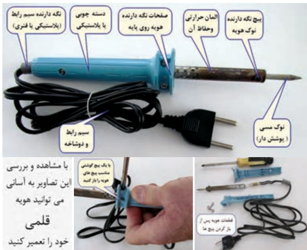
شکل ۲۷-۱- قسمت‌های مختلف یک هویه قلمی
