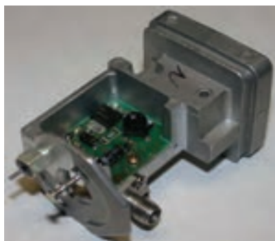
شکل ۲۹-۲ LNB و مدار داخل آن
