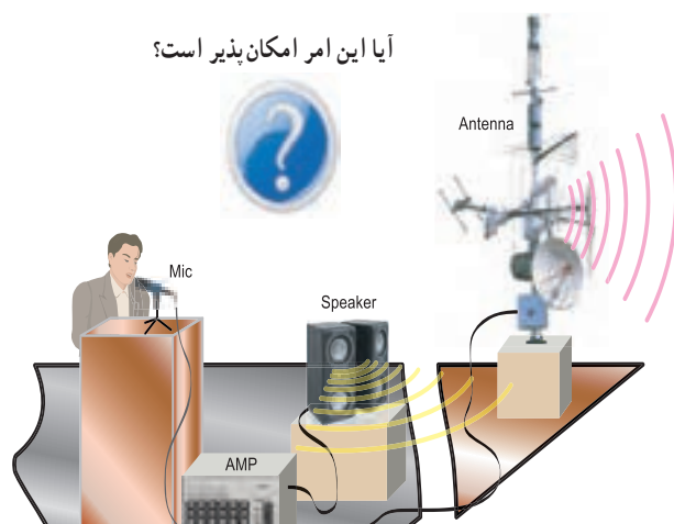
شکل ۷-۳- تبدیل امواج صوتی به امواج الکترومغناطیسی
