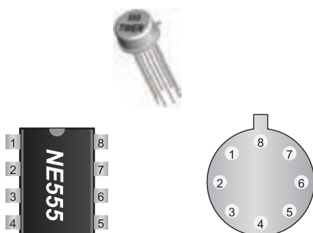
شکل ۵-۵۸- نوع محفظه ها و شماره پایه های آی سی ۵۵۵
