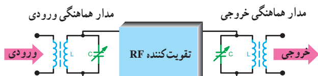
شکل ۴-۲ یک تقویت کننده رادیویی با مدار هماهنگی در ورودی و خروجی
