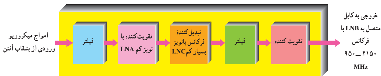
شکل ۲۷-۲ بلوک دیاگرام ساده LNB
