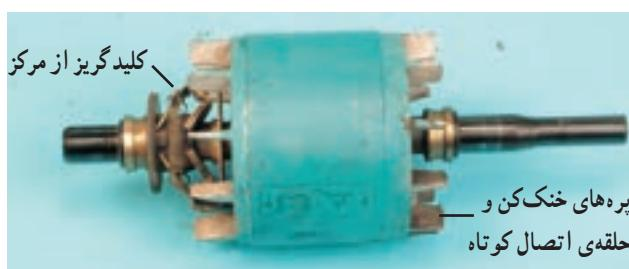
شکل ۸-۷—روتور یک موتور کولر با پرهای خنک کن و کلید گریز از مرکز
