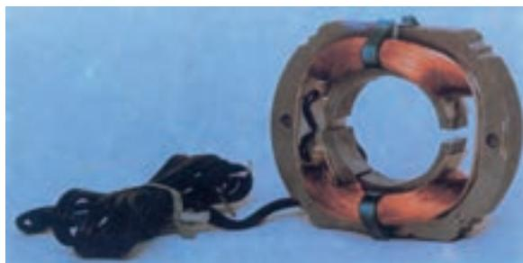
شکل ۸-۱۴- استاتور و هسته پمپ آب
