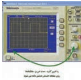
شکل ۴۸-۶- تغییر کلید Volt/Div و نمایش شکل موج
