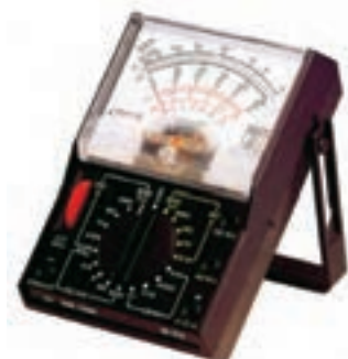
شکل ۲۲-۲ یک نمونه مولتی متر را که قسمتی از آن به عنوان ولت متر DC است نشان می دهد.
