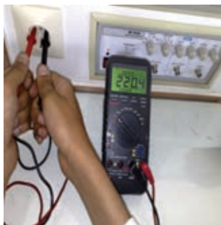
شکل ۶-۳۱ اندازه گیری ولتاژ متناوب برق شهر توسط مولتی متر
