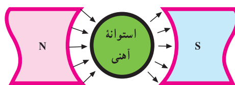
شکل ۵-۳ چگونگی ایجاد میدان مغناطیسی یکنواخت و شعاعی
