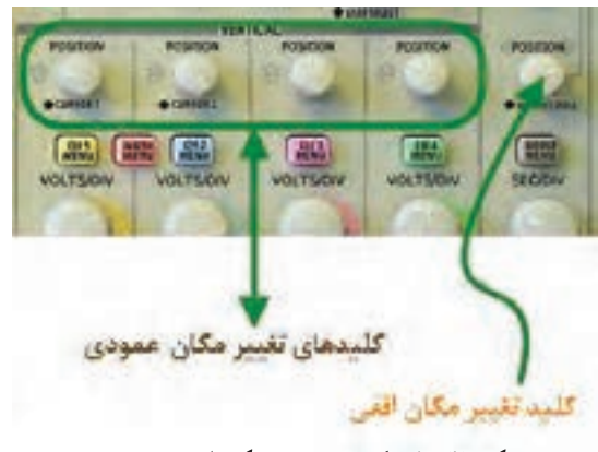
شکل ۶-۴۳ کلیدهای تغییر مکان افقی و عمودی
