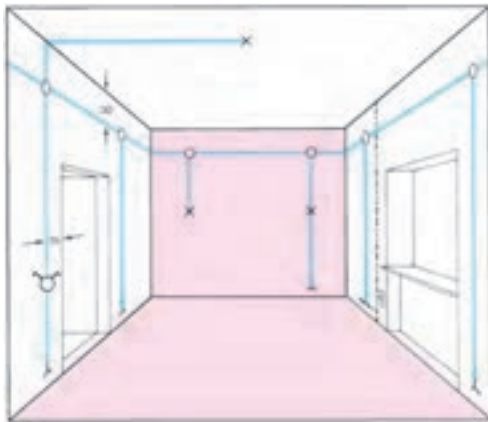
شکل ۶-۵ سیم‌کشی توکار با استفاده از جعبه تقسیم
