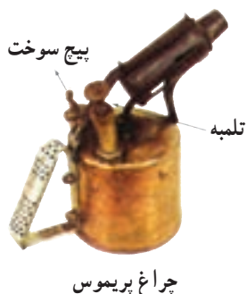
شکل ۳-۴ هویه‌ی ساده و دستگاه گرم‌کننده‌ی آن
