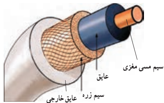
شکل ۷-۹ - اجزای تشکیل دهنده کابل کواکسیال
