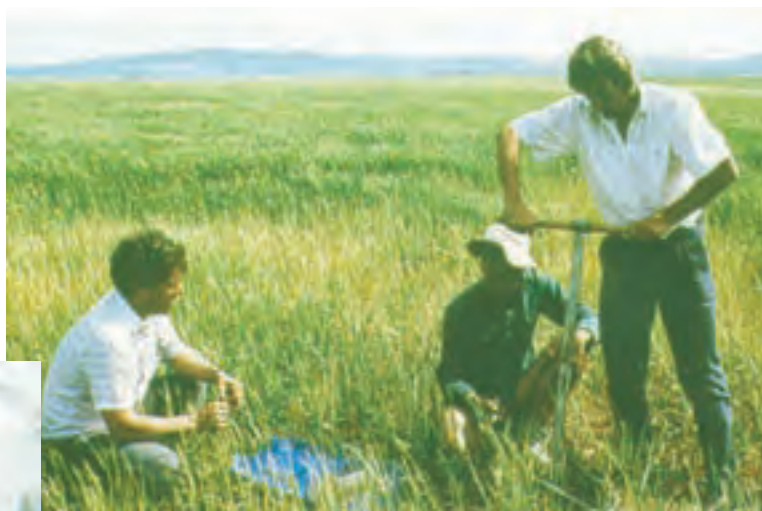
شکل ۱۳-۱ نحوه کار با اوگر
