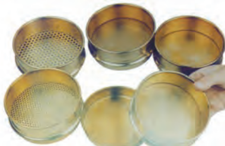
شکل ۲۱- ۱ انواع الک که در تجزیه مکانیکی خاک مورد استفاده قرار می‌گیرند.
