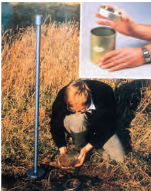
شکل ۱۶- ۱ نمونه برداری از خاک با سیلندر
