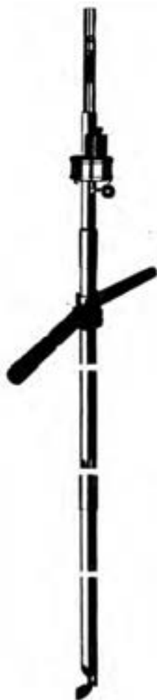
شکل ۳-۵- سوند فستوکسین برای قرص گذاری در داخل توده غله
