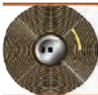
شکل ۳-۴ نمایش شیار، سکتور و کلاستر
