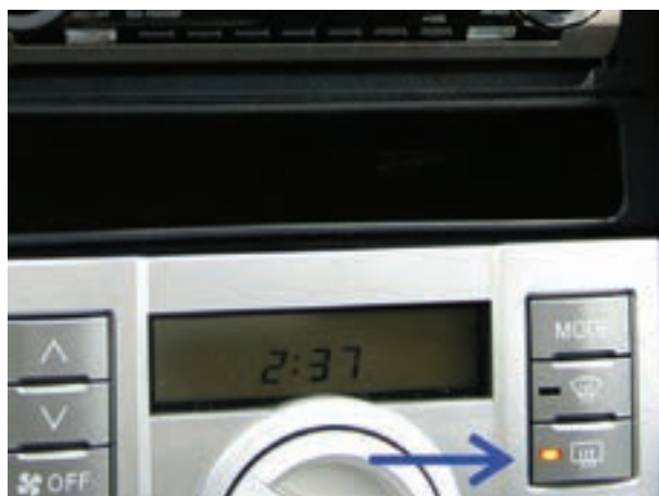
شکل ۳-۱۷- سوئیچ شیشه گرم‌کن در حالت (on)
