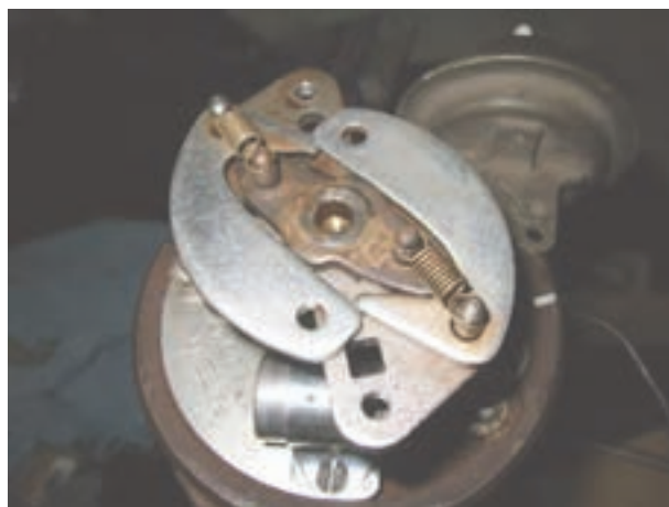
شکل ۲۴-۱۰ دستگاه آوانس وزنه‌ای دلکو
