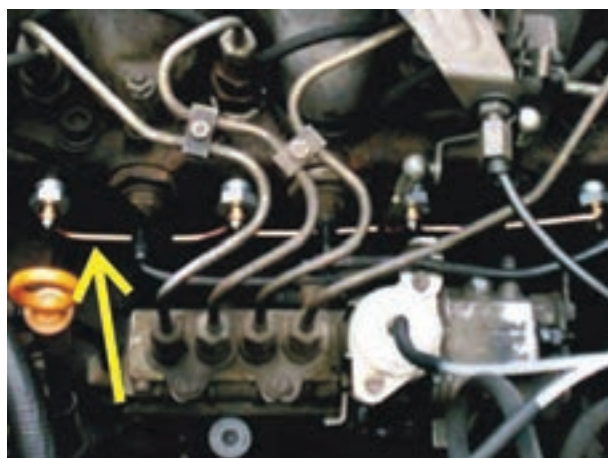
شکل ۷-۱۳- اتصال سری شمع گرم کن
