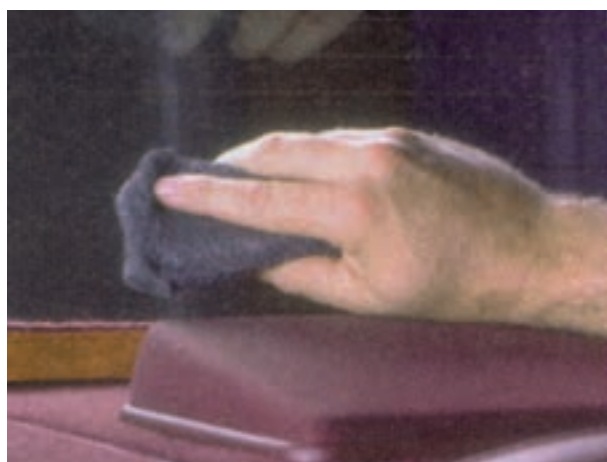
شکل ۳-۲۲- تمیز کردن محل قطع شده‌ی المنت حرارتی
