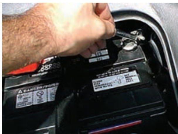
شکل ۳-۱۲- بستن کابل اتصال بدنه‌ی باتری
