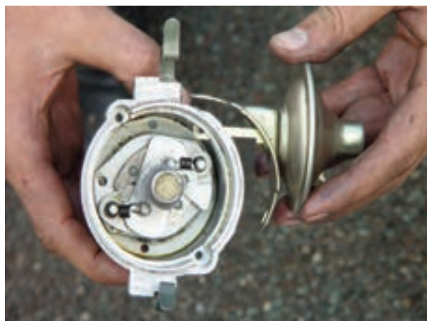
شکل ۳۱-۱۰ جدا کردن مجموعه‌ی آوانس خلئی
