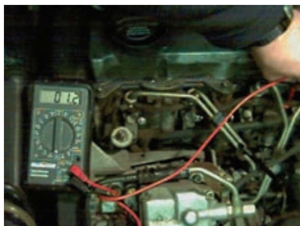
شکل ۱۳-۲۳ اندازه‌گیری مقاومت شمع گرم‌کن سیلندر چهارم
