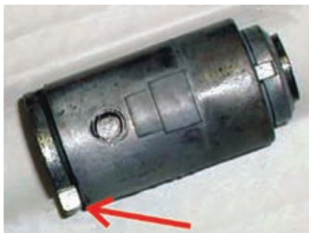
شکل ۱۹-۱۱- مغزی سوئیچ اصلی موتور
