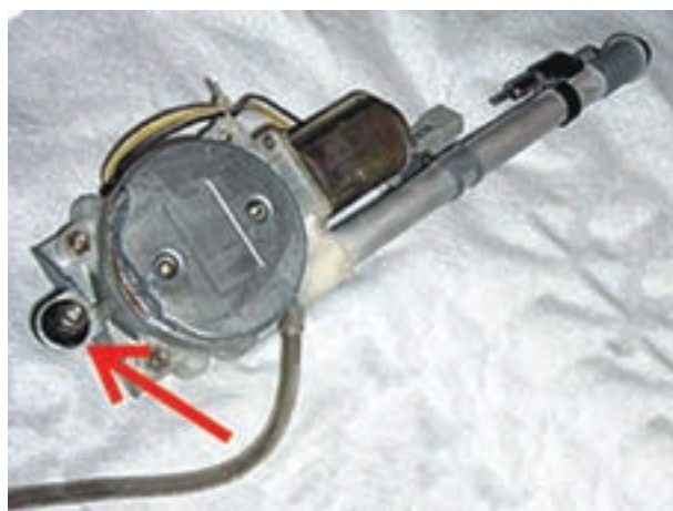
شکل ۵-۲۲- آنتن الکتریکی پس از پیاده کردن آن
