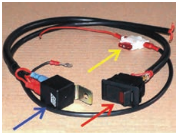
شکل ۳-۱۱- دسته سیم مدار الکتریکی شیشه گرم کن
