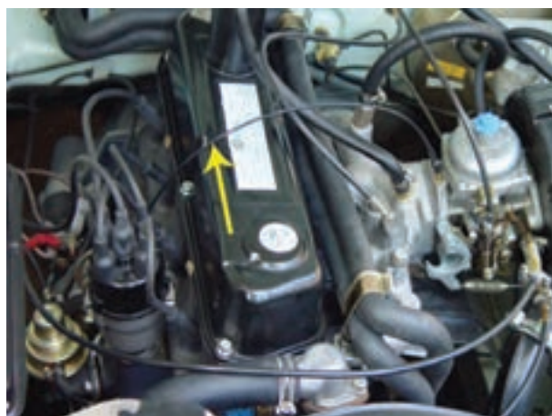
شکل ۲۸- ۱۰- لوله‌ی رابط آوانس خلثی به کاربراتور
