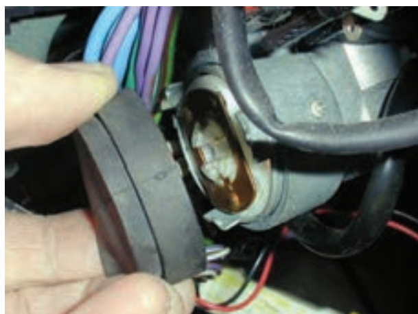
شکل ۱۱-۱۳- بیرون آوردن فیبری پشت سوئیچ
