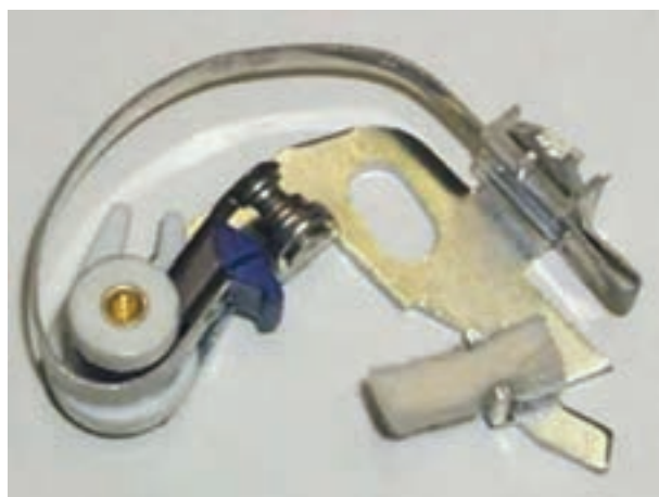
شکل ۲۲-۱۰ نمد روغن کاری بادامک
