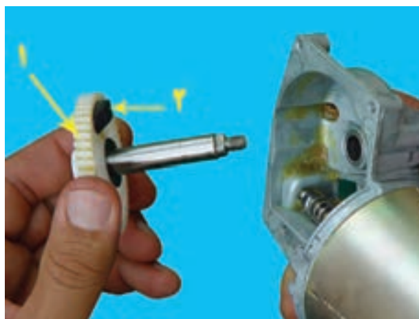
۱- چرخ دنده ۲- بادامک محرک زائده پلاتین
