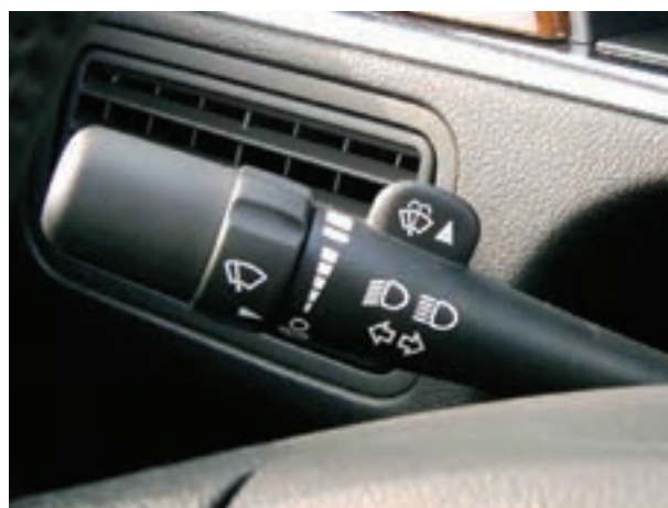
شکل ۲-۱۰- سوئیچ برف پاک کن تایمردار
