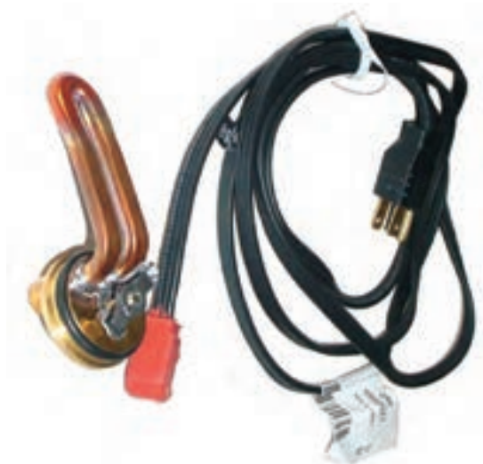
شکل ۱۰-۱۳ گرم کن آب موتور
