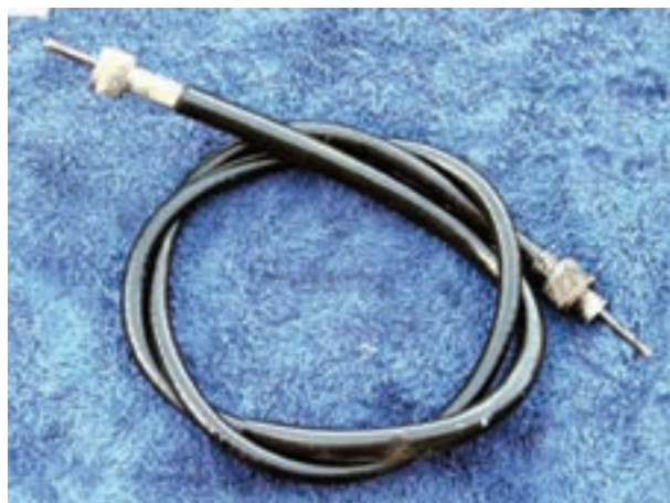
شکل ۱۲-۷- سیم کیلومتر
