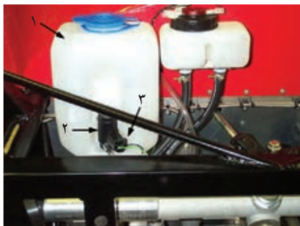
شکل ۷-۲- مخزن و پمپ آب شیشه‌شوی
