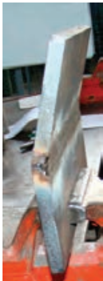
دو قطعه کار با ضخامت حدود ۱۵ میلی متر در اثر جوشکاری با طرح اتصال V حدود ۲۰ درجه دچار پیچیدگی زاویه ای شده اند.
