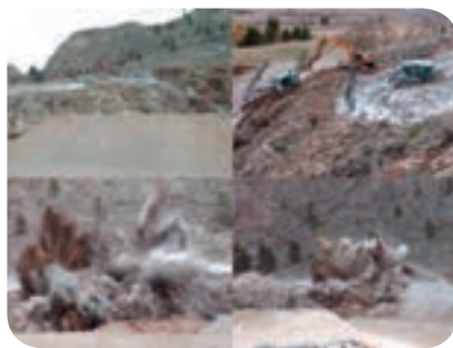
استخراج سنگ های معدنی توسط ماشین های مکانیکی و به کمک مواد منفجره
