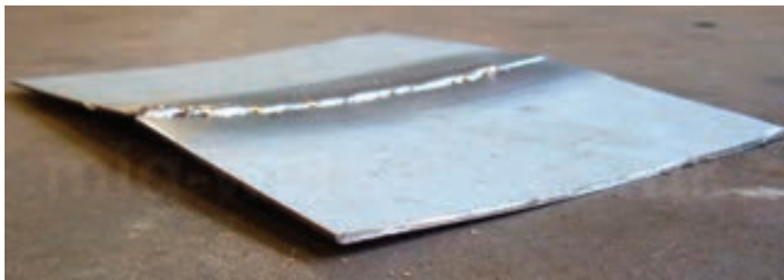
تاب برداشتن ورقه فولادی که بدون قید و بند به وسیله جوشکاری به هم متصل شده‌اند
