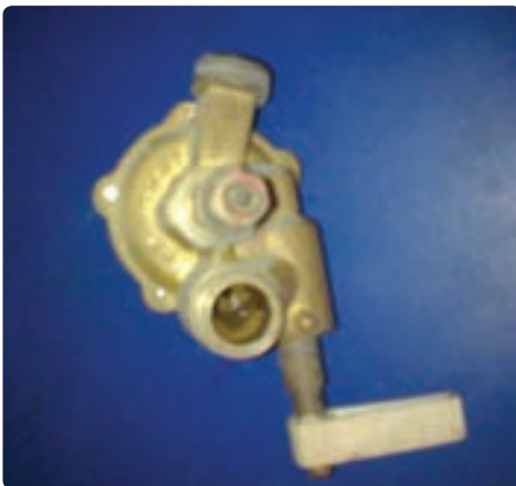
شکل ۹-۱- رگولاتور آب
